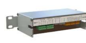
Sistema Openlinx Interconector e controlador de portas. Gestão remota do funcionamento das portas automáticas a partir de navegador web e integração com buses de comunicação industriais e imóticos.
